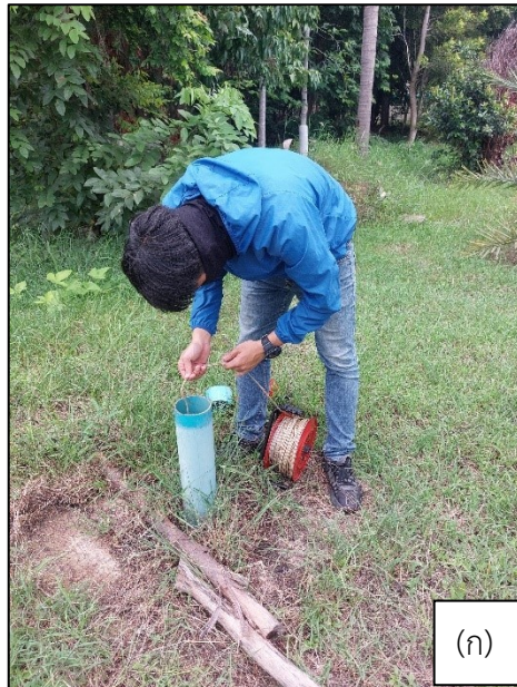
รูปที่ 5.1.3-11 การสำรวจ และวัดระดับน้ำ บ่อสังเกตการณ์ (ก) และบ่อบาดาลจากประปาหมู่บ้าน (ข) ณ วันที่ 24 กรกฎาคม 2567 (ครั้งที่ 2)
