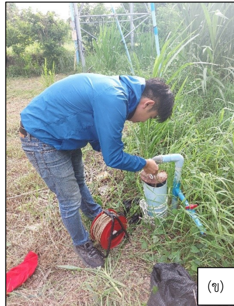
รูปที่ 5.1.3-11 การสำรวจ และวัดระดับน้ำ บ่อสังเกตการณ์ (ก) และบ่อบาดาลจากประปาหมู่บ้าน (ข) ณ วันที่ 24 กรกฎาคม 2567 (ครั้งที่ 2)
