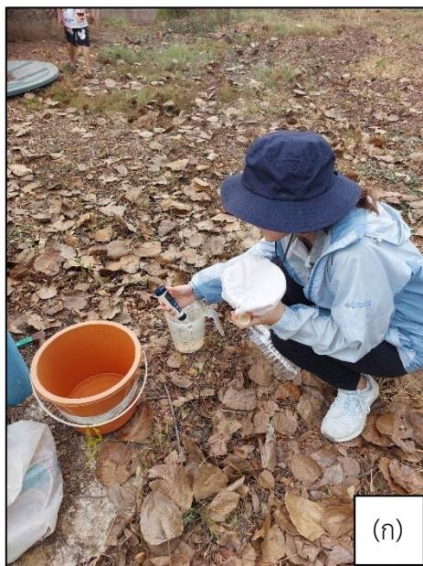
รูปที่ 5.1.3-11 การสำรวจ และวัดระดับน้ำ บ่อสังเกตการณ์ (ก) และบ่อบาดาลจากประปาหมู่บ้าน (ข) ณ วันที่ 24 กรกฎาคม 2567 (ครั้งที่ 2)
