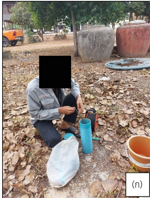
รูปที่ 5.1.3-9 การสำรวจ และวัดระดับน้ำ บ่อสังเกตการณ์ (ก) และบ่อบาดาลจากประปาหมู่บ้าน (ข) ณ วันที่ 20-21 มีนาคม 2567 (ครั้งที่ 1)
